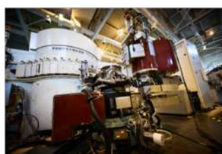
Fig. 6: 藤田研究室が管理している中性子三軸分光器AKANEの写真(左)とAKANEで測定した銅酸化物高温超伝導体のフォノン分散(右)。
