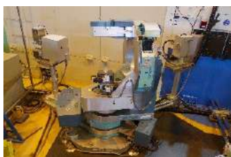
Fig. 2: 木村研究室が管理運営している中性子単結晶構造解析装置FONDER (左)と、現在開発中の大面積中性子二次元 3 He検出器を用いた中性子カメラ (右)。
