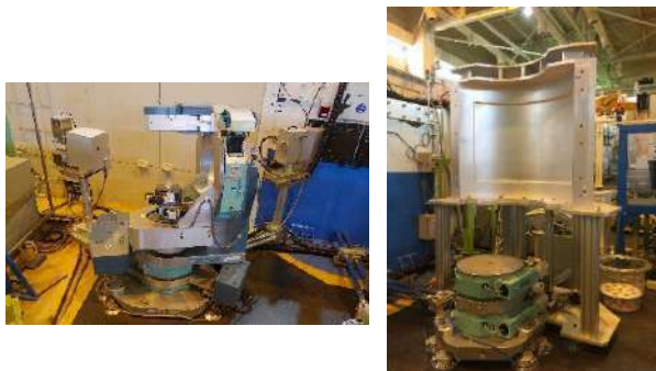
Fig. 1: 木村研究室が管理運営している中性子単結晶構造解析装置FONDER (左)と、現在開発中の大面積中性子二次元 3 He検出器を用いた中性子カメラ (右)。
