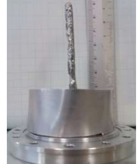
中性子回折実験のためにアーク溶解により作製したFeMnMo多結晶合金。
