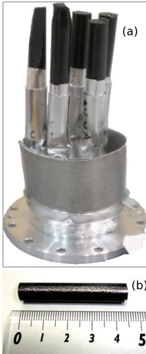
図 19: (a) 育成した単結晶 5 本をアSEMBルしたもの (b) 単結晶一本の図
